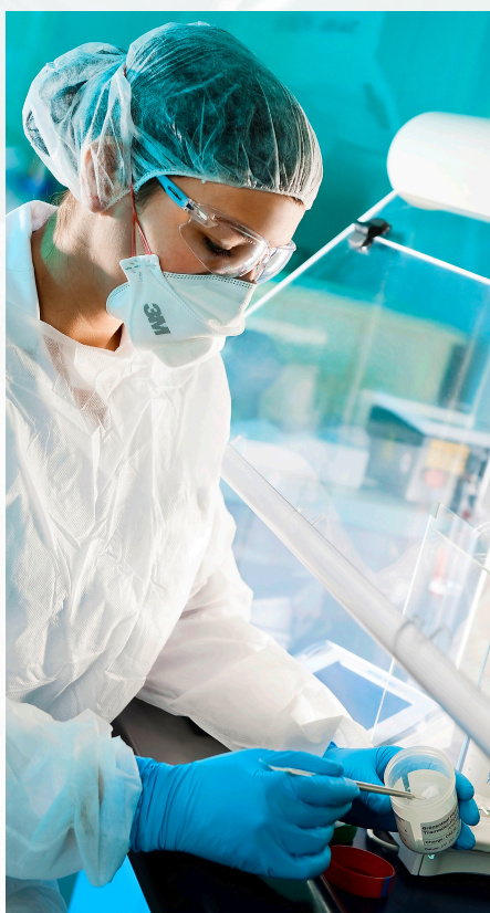
Handhabung von HPAPI in einer Sicherheitswerkbank.
