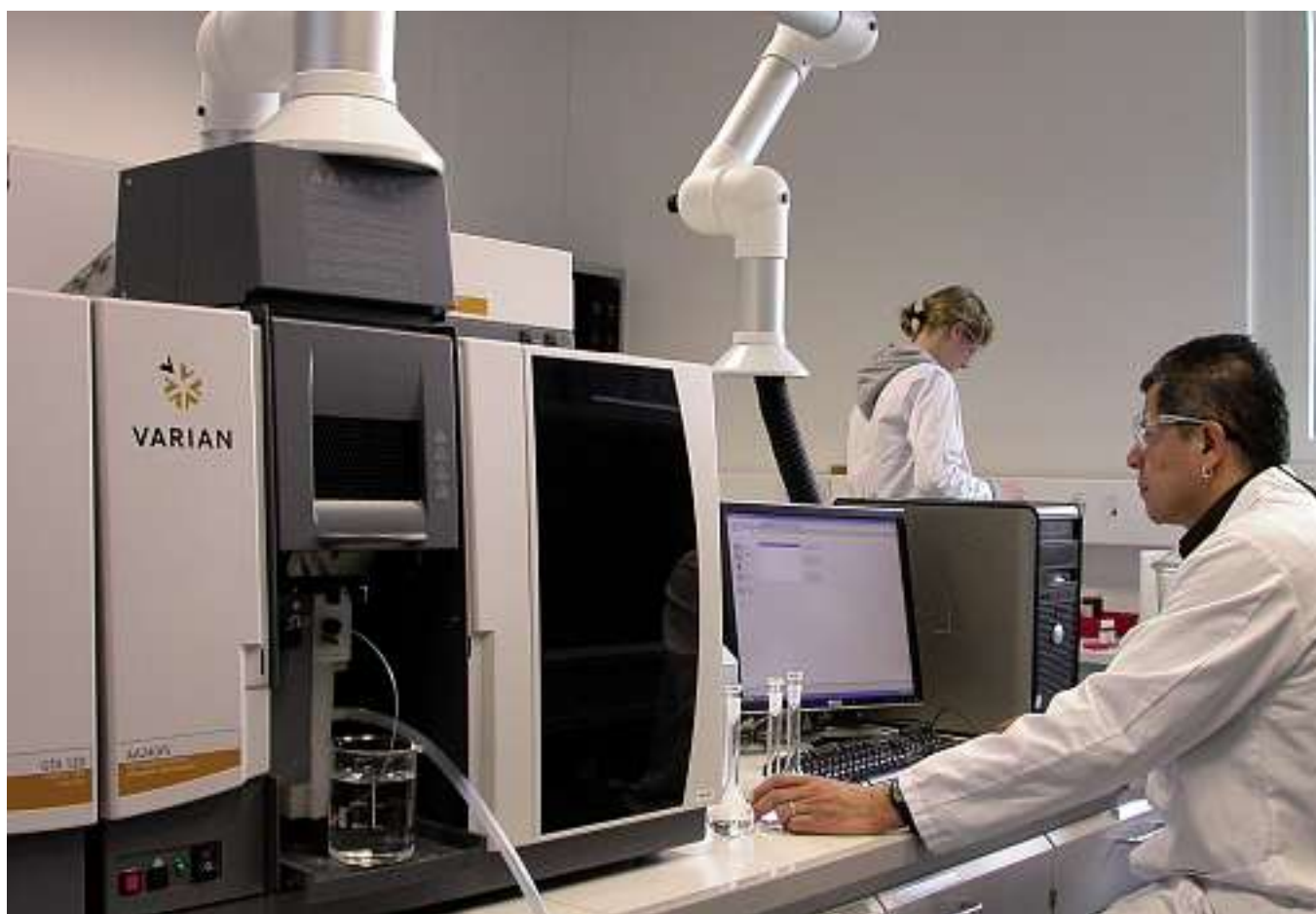
Flamme/Graphitrohr-AAS (Atomabsorptions-Spektrometer) zur Analyse und Beurteilung von Schwermetallrückständen.
