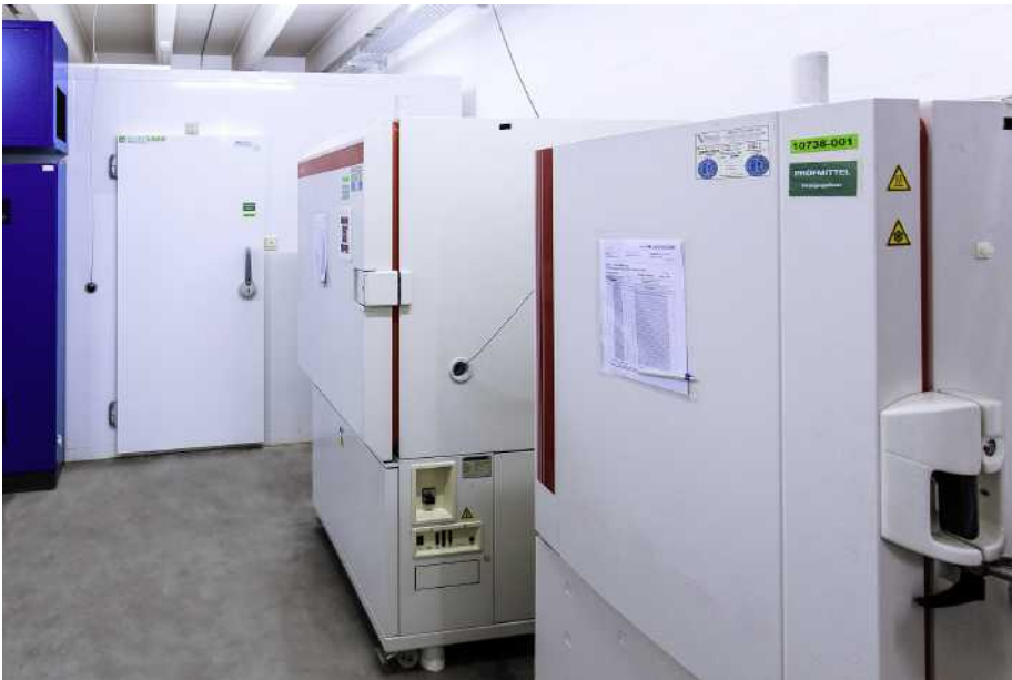
Blick in das Stabilitätscenter der UFAG: In insgesamt 22 Klimakammern und -schränken werden pharmazeutische Produkte unter kontrollierten Bedingungen gelagert.
