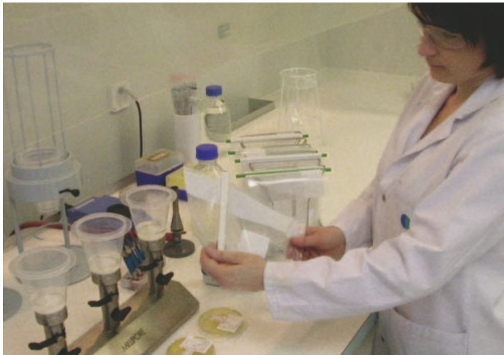
Membrantitration der Extraktionsflüssigkeit im Laminarflow nach dem beendeten Extraktionsverfahren.
