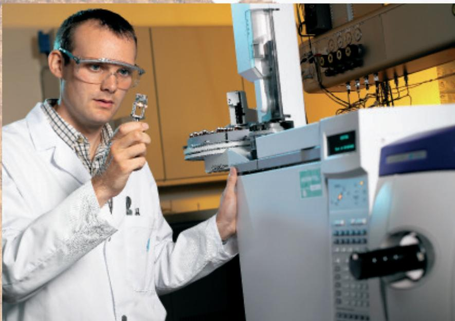
**Pestizidanalytik mit GC-Tandemmassenspektrometer**
